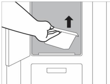
Slika 15. Smjernice uklanjanja ložišta
