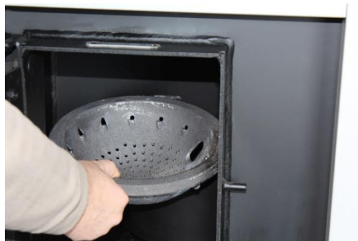
Slika 19 i 20. Čišćenje gorionika
