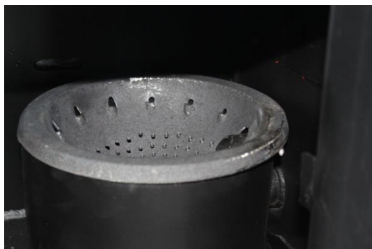
Slika 19 i 20. Čišćenje gorionika
